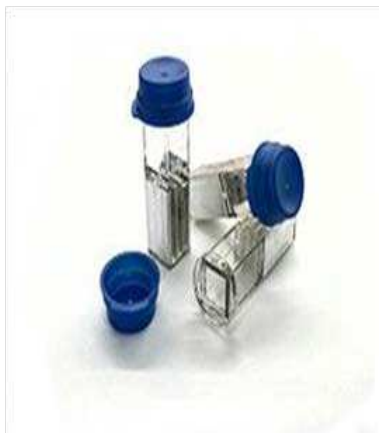
Пластиковые кюветы с алюминиевыми электродами, используемые для электропорации
