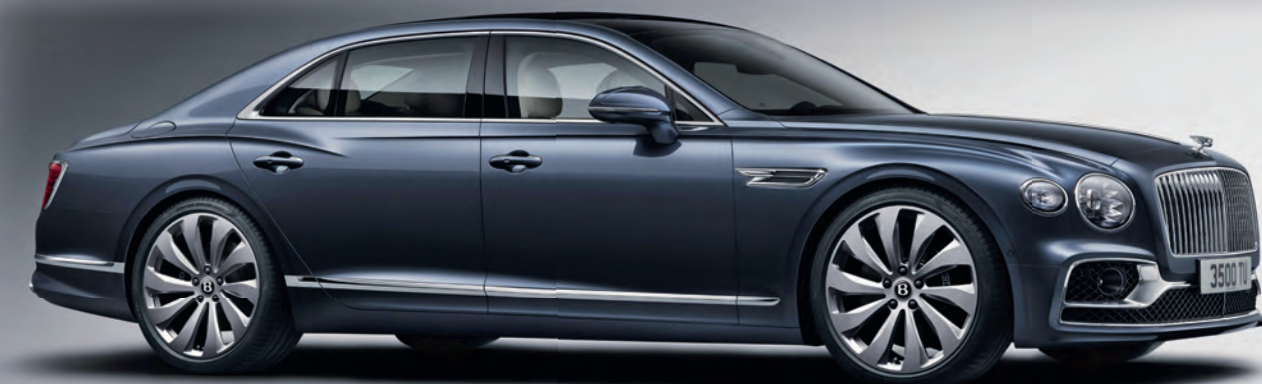
“Flying Spur” – первая модель “Bentley” с полноуправляемым шасси, активным полным приводом и адаптивной подвеской.
